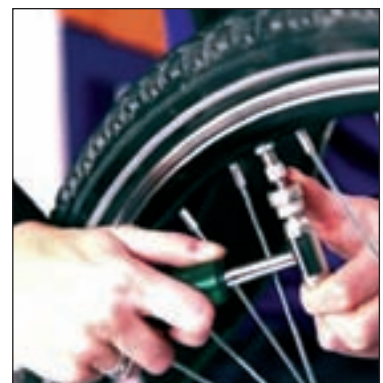
Doppelkopfaufsatz passt auf alle gängigen Ventile
