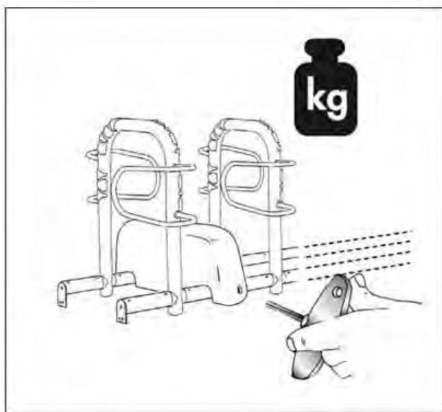
Fäst med Beta-Poller betongblock.
